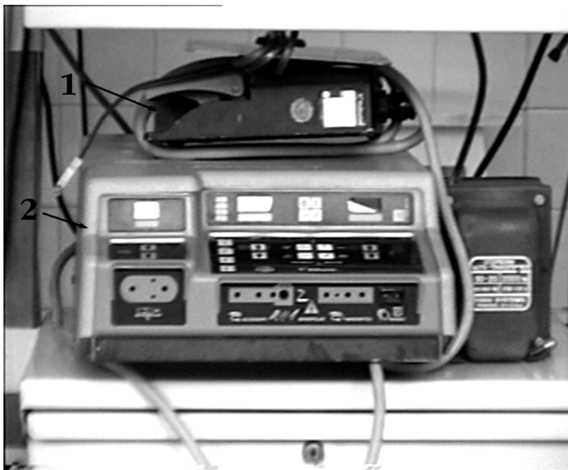
Рис. 10 Электрохирургический блок фирмы "Valleylab"(США) 1 - ножной блок управления ; 2 - основной блок.
